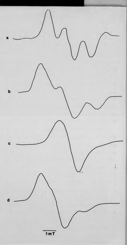
Fig. 5.11(a-d) Experimental ESR Spectra of TFPZ $^+$ -DNA Fibres and Gel (a) 0° (b) 45° (c) 90° (d) Gel.
